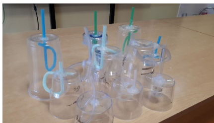
Рис. 3. Сифоны, изготовленные из одноразовых стаканчиков. Сифоны перевернуты, так как выходная трубка не дает возможности устойчиво их поставить
