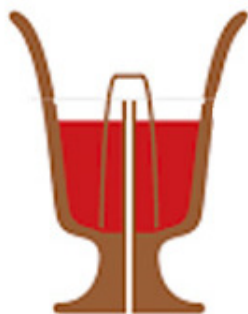
Рис. 7. Внутренне устройство «Кружки Пифагора» (слева) и наша реализация такого сифона (в центре и справа)
