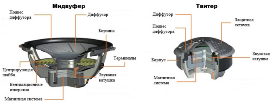
Рис. 1. Устройство динамика
