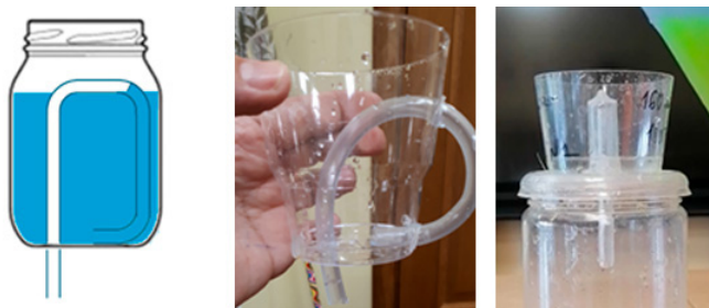
Рис. 5. «Одноминутный сифон»: слева – принципиальное устройства и процесс заполнения, в центре – сифон из стакана и трубки, справа – сифон в форме «трубки Пифагора»
