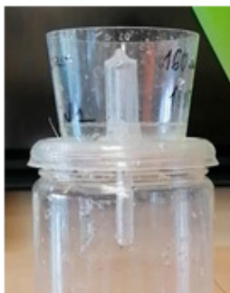
Рис. 7. Внутренне устройство «Кружки Пифагора» (слева) и наша реализация такого сифона (в центре и справа)
