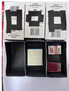
Рис. 5. Пинхолы с фокусными расстояниями: 50 мм, 37 мм и 20 мм
