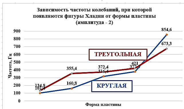
Рис. 5. Зависимость частоты колебаний от формы пластины (треугольная пластина) Изучение зависимости конфигурации фигур Хладни для квадратной пластины и сыпучей среды
