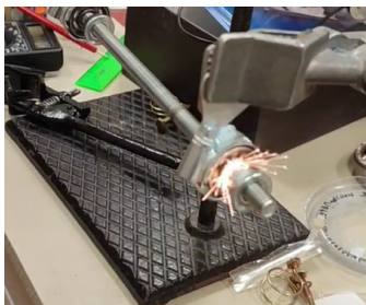
Рис. 4. Искры при плохом контакте подшипника с осью (шпилькой с резьбой М8).
