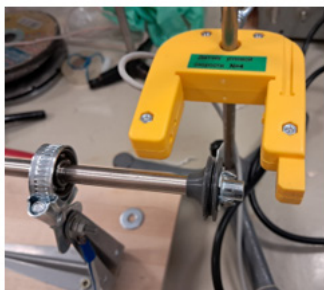
Рис. 3. Измерение частоты вращения с помощью датчика угловой скорости (слева). Зависимость частоты вращения от времени после запуска (справа)
