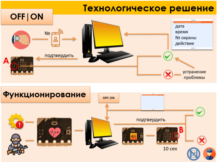
Рис. 3. Графическое изображение алгоритма функционирования охранной системы «Security Next»
