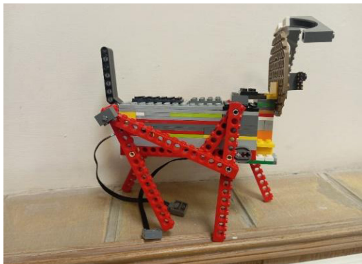
Рис. 2. Шагающий механизм робота
