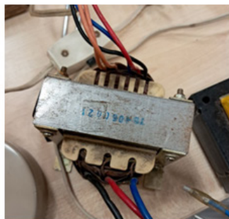
Рис. 2. Старый трансформатор от источника бесперебойного питания (слева) и способ соединения обмоток (справа) для изготовления нового трансформатора
