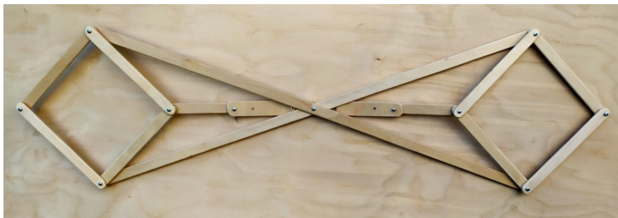
Рис. 2. Общий вид авторской запатентованной модели сдвоенного механизма Липкина
