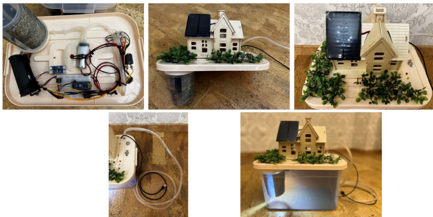
Рис. 2. Макет собранной системы для отслеживания уровня заполнения выгребной ямы
