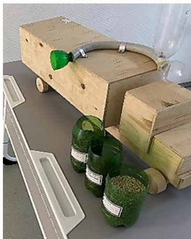
Рис. 1. Конструкция для аэродинамического посева растений-ремедиаторов
